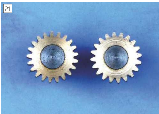
20T and 21T Mod 0.6 gears on standard 21T OD
